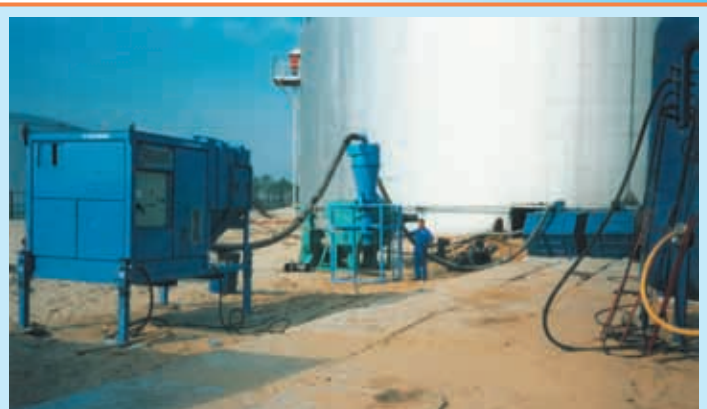
Всасывающие установки и принадлежности в мобильном варианте (автоматическое пылеудаление через двойной магнитный шлюз)
