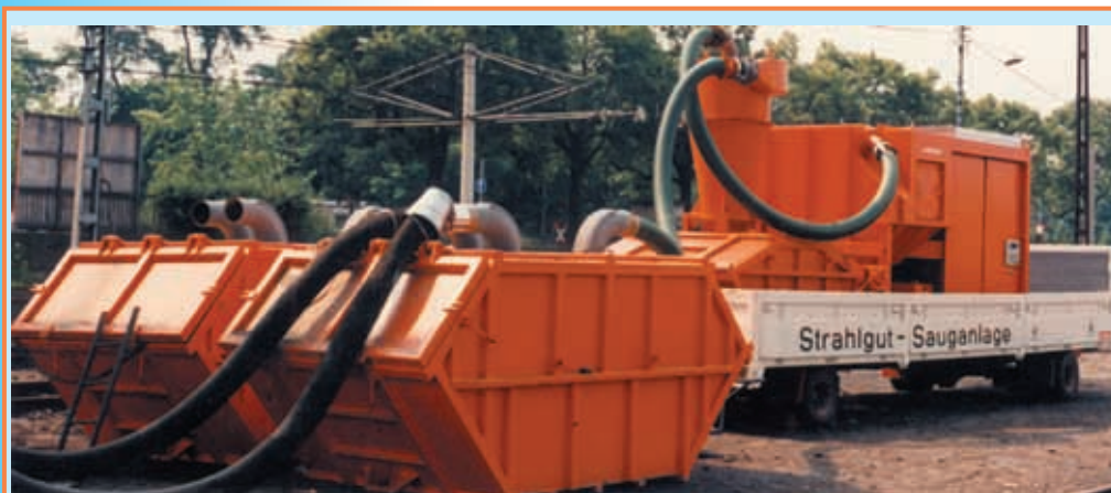
Всасывающая установка со сменными контейнерами отработанного абразива и циклонным пылеотделителем
