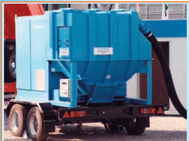
Дизельная всасывающая установка на передвижном шасси «Тандем». Имеет разрешение на передвижение по автодорогам
