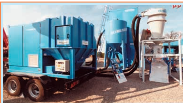
Всасывающая установка с вакуумным силосом и автоматическим пылеотделением.
