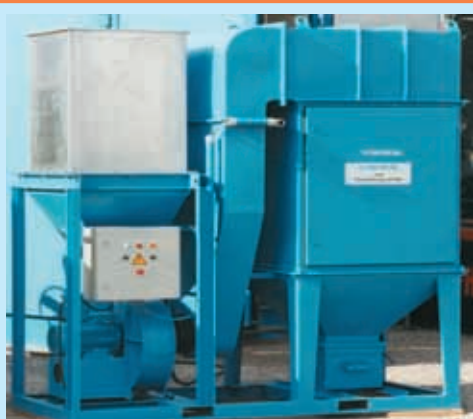
Передвижная фильтровальная установка 5.000 м³/час с патронными фильтрами
